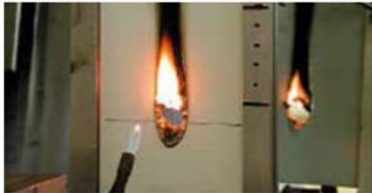
Kleimbrennertest gemäss EN ISO 11925-2
