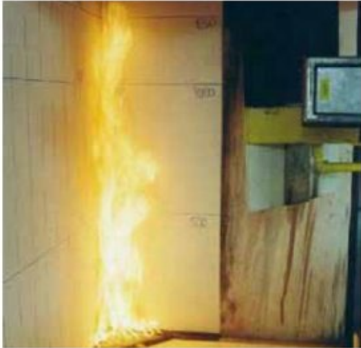
SBI-Prüfung nach EN 13823
